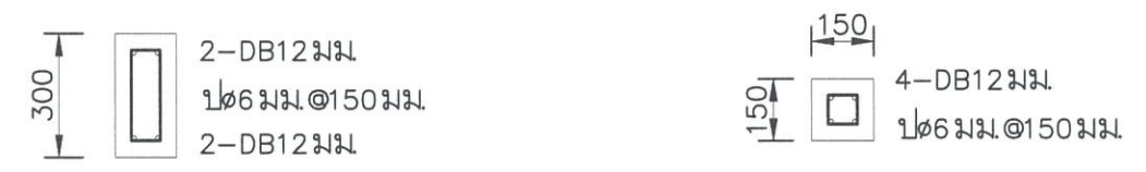
ALL SPAN รายละเอียดเหล็กเสริมคานค.ส.ล. B1 รายละเอียดเหล็กเสริมเสา ค.ส.ล. C1
